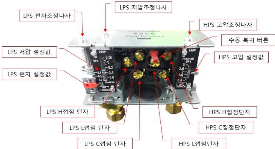
[그림 2-13] 압력스위치(Dual Pressure Switch, DPS)
