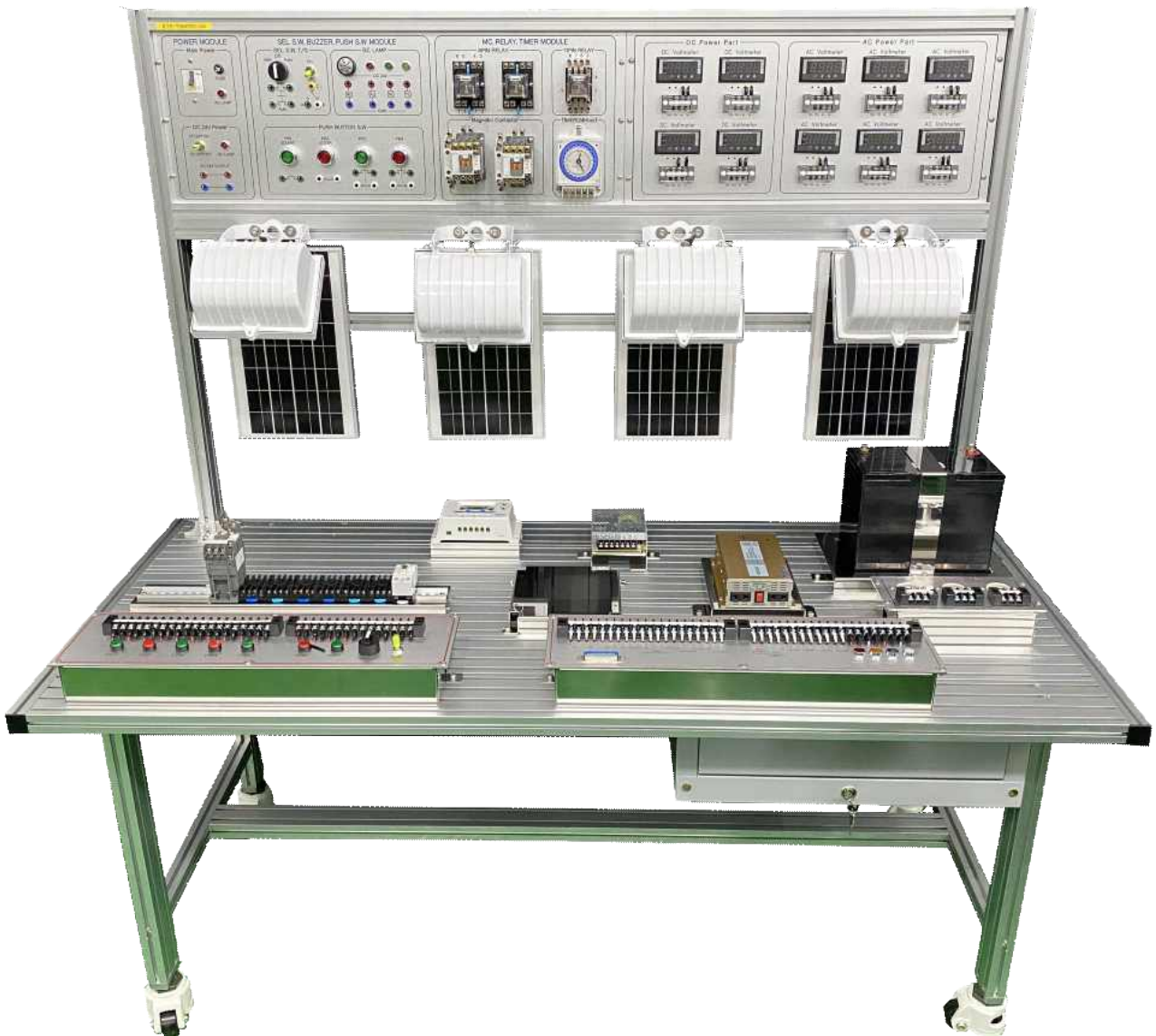
[그림 1-1] 태양광 발전 설비 실습장비
